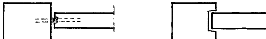
Fig. 10.19 Verbinding tussen brandmuren en kolommen
